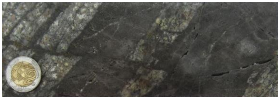
Figura 3. Pórfido temprano EP con vetillas tipo A (<7 cm de ancho) de cuarzo granular. La alteración clorita-sericita está sobrepuesta en partes por alteración argílica avanzada (DDH-02, 317.6 m).
