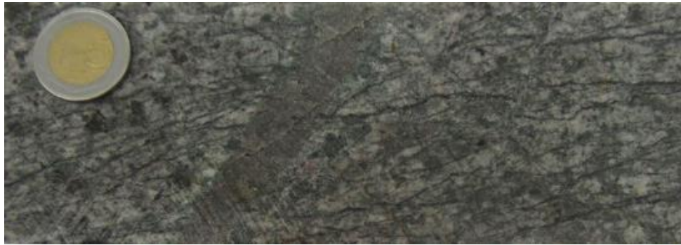
Figura 5. Vetillas milimétricas de magnetita tipo M (líneas delgadas de color negro) cortadas por una vetilla tipo A de cuarzo granular. La alteración potásica (feldespato potásico, biotita hidrotermal) está sobreimpuesta por débil alteración clorita-sericita. Pirita y calcopirita (no visibles) están diseminadas en las vetillas y matriz. (DDH-13, 504.3 m).
