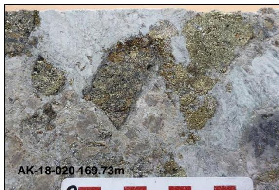
Figura 5. Brecha polimíctica con alteración argílica intermedia y clastos mineralizados de esfalerita-galena-calcopirita del sistema ANK-05.
