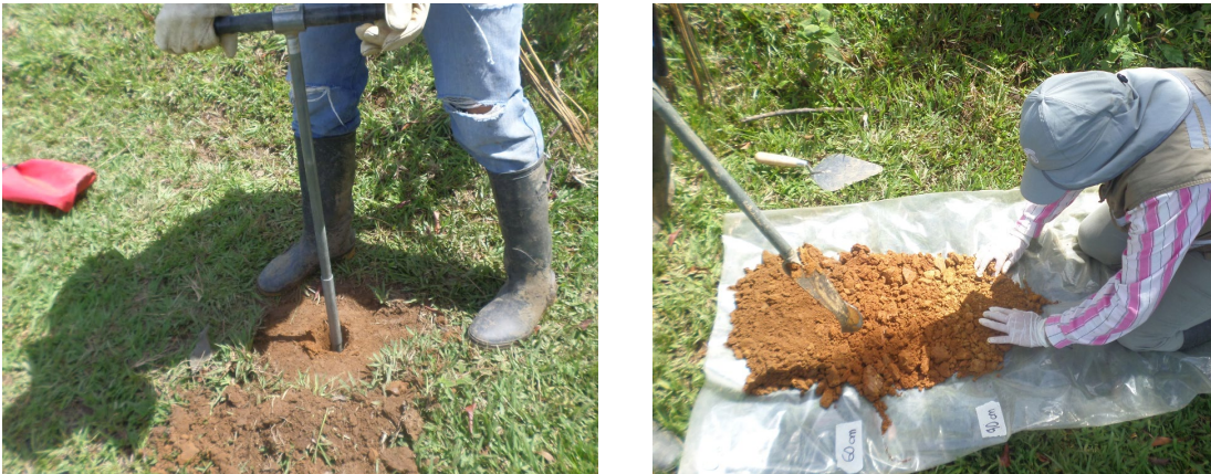
Fig. 2.2.2.8 - Toma de muestra de suelo con barreno tipo Auger.
