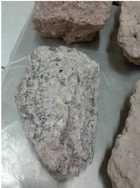
Figura 3.1.9 Muestra de roca antes de trituración
