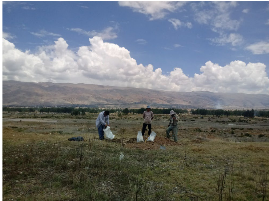
Imagen: Muestreo geoquímico de suelos en el valle del Mantaro, provincia de Huancayo y departamento de Junín, Perú.
