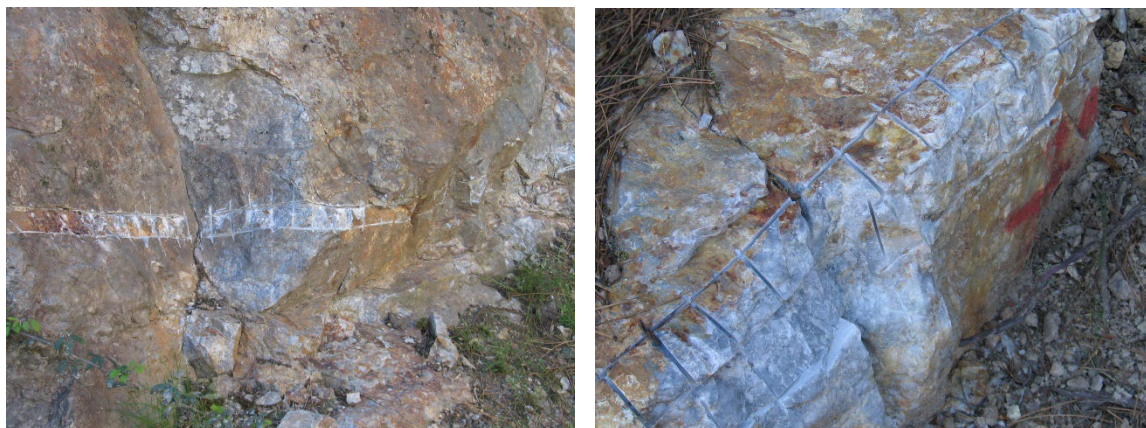
2.2.1.17b – Muestreo de rocas en canal para exploración de estaño en Ervedosa, Trás-os-Montes, Portugal. Foto de Daniel de Oliveira (2009)
