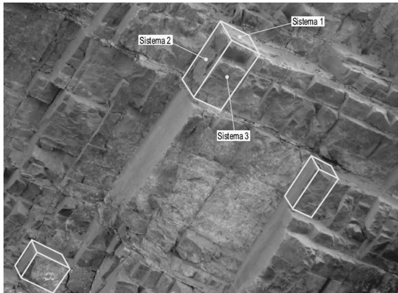
**Figura 6.29. Representación espacial de los sistemas de discontinuidades para la estimación del índice de tamaño. Fotografía y montaje: David Córdova.**
