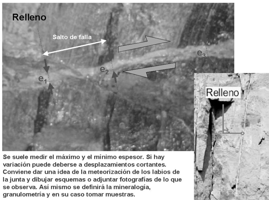
Figura 6.23. Medición y análisis de rellenos. Fotografía y esquema: autores y David Córdova.
