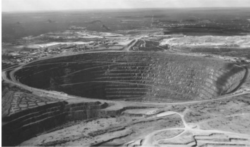
Figura 8.2. Ejemplo de corta de cobre en su fase final de desarrollo y de dimensiones mucho mayores que el ejemplo que se presenta de forma simplificada para su análisis. Corta de cobre de Palabora en Sudáfrica. Según <http://www.mining-technology.com/projects/palabora/palabora2.html>.
