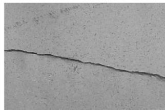
**Discontinuidad rellena,** existe un material de relleno entre ambos labios de la discontinuidad.
