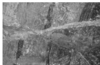
Figura 6.21. Definición de discontinuidad cerrada, abierta y rellena. Fotografía y montaje: autores.
