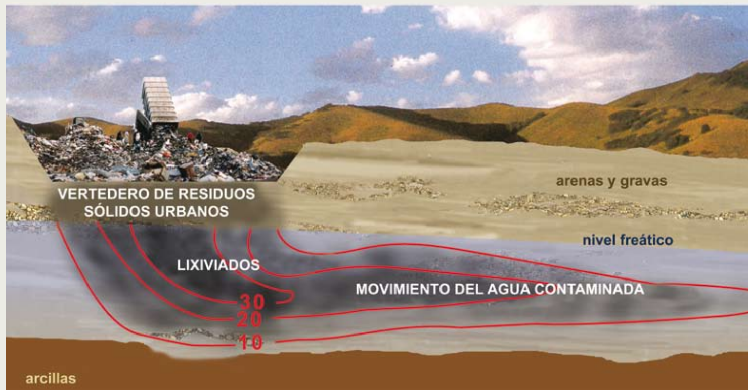
Penacho contaminante en un vertedero con fugas de lixiviado (isocontenidos de amonio [NH_4^+] en mg/L)
