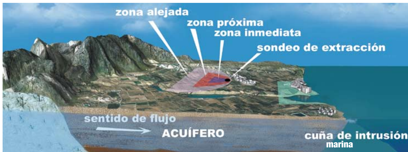
Esquema que representa las diferentes zonas de protección de la calidad del agua subterránea en un pozo destinado al abastecimiento urbano
