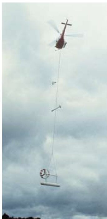
Aplicación de métodos geofísicos aerotransportados al estudio de acuíferos
