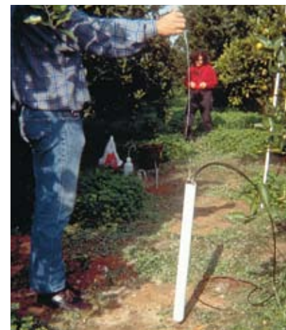
Parcela experimental situada en el acuífero de La Plana de Castellón, para estudiar los procesos de contaminación del agua subterránea por plaguicidas
