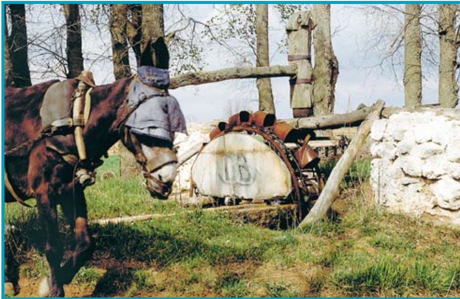
Antigua forma de extracción de agua mediante noria movida por tracción animal
