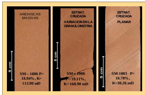
Figura 5. Fotos de núcleos, areniscas eólicas de Noi Inferior.
