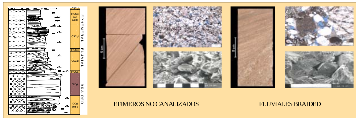
Figura 16. Núcleo del pozo san Martín 1002, reservorio Nia medio, grafico interpretado “selley” y fotos
