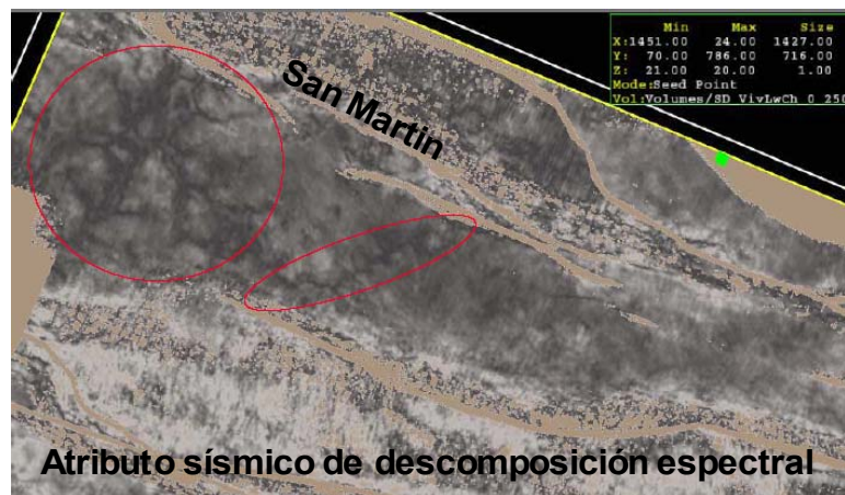
Figura 23. Sección horizontal del atributo sísmico de descomposición espectral mostrando formas con apariencia de canales de marea sobre Vivian en el yacimiento de san Martín.
