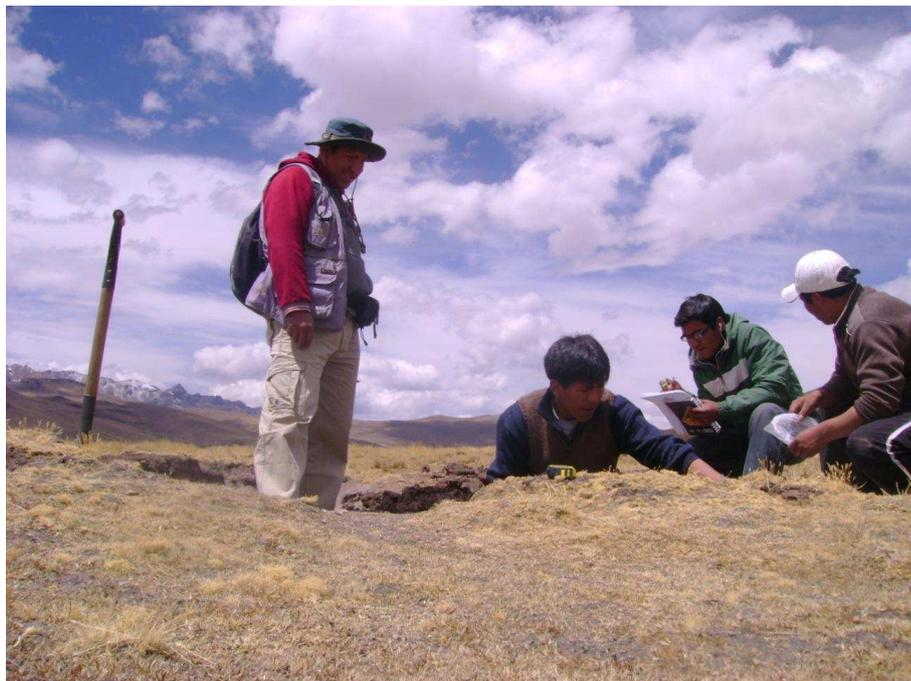
**Foto 40:** Trabajos de muestreo de suelos de origen aluvial y descripción de tipo litológica en Pinaya – Santa Lucia.
