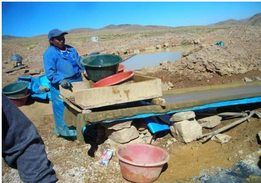
**Foto 34:** Laboreo minero artesanal para la obtención de oro en partículas sueltas en material aluvial hechos al oeste del Centro Poblado de Cabanillas a 5000 m.s.n.m (fuente Guillen 2010).
