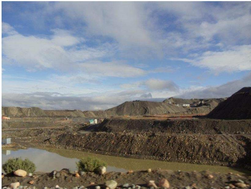
**Foto 33:** Trabajo minero de material mineralizado hecho por cooperativas en las pampas de Ananea y Pampa Blanca (Provincia de San Antonio de Putina), el material mineralizado consta de morrenas en donde el oro se encuentra en partículas sueltas. (Carretera Lampa-Palca; 333033E, 8313819N, 3900 m.s.n.m; mirando al NW).
