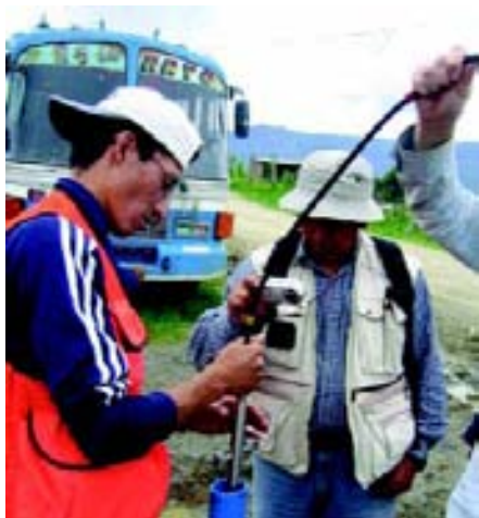
Figura 21. Colocación de un inclinómetro dentro de una perforación para medir movimientos horizontales a lo largo de la perforación y detectar la localización en profundidad de la superficie de rotura sobre la cual el material se moviliza.
