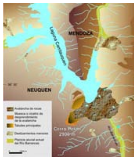
Figura 31. Esquema de la avalancha de rocas del Cerro Pelán que endicó el río Barrancas.
