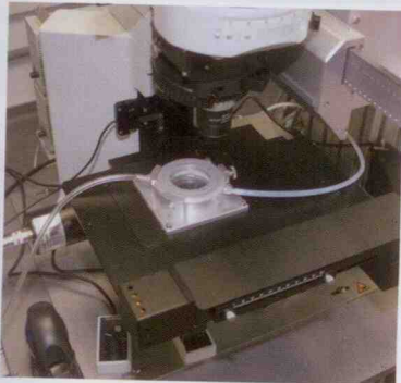
▲ Photographie de l'équipement d'ablation laser couplée à l'ICPMS (LA-ICPMS) installé au laboratoire GzR, Nancy. Photographie de l'inclusion fluide avant et après ablation. Spectre de masse obtenu après ablation laser et analyse d'une inclusion fluide.
