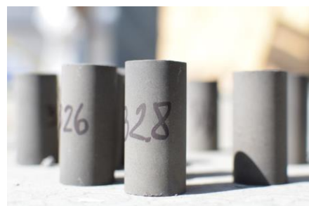
Fig. 4 – Probetas obtenidas a partir de ceniza volcánica.
