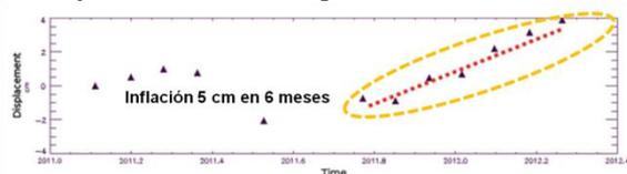
Fig. 5 – Patrón de deformación inflacionario (2011-2012) previo al inicio del ciclo eruptivo.
