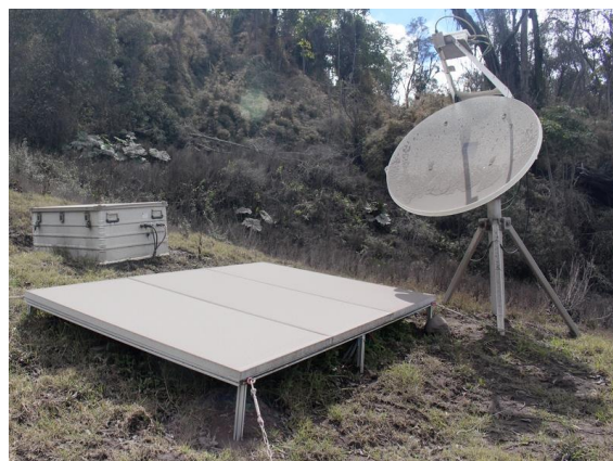
Fig. 1 – Micro Rain Radar instalado en el volcán Turrialba cubierto de ceniza el 10 de enero del 2018
