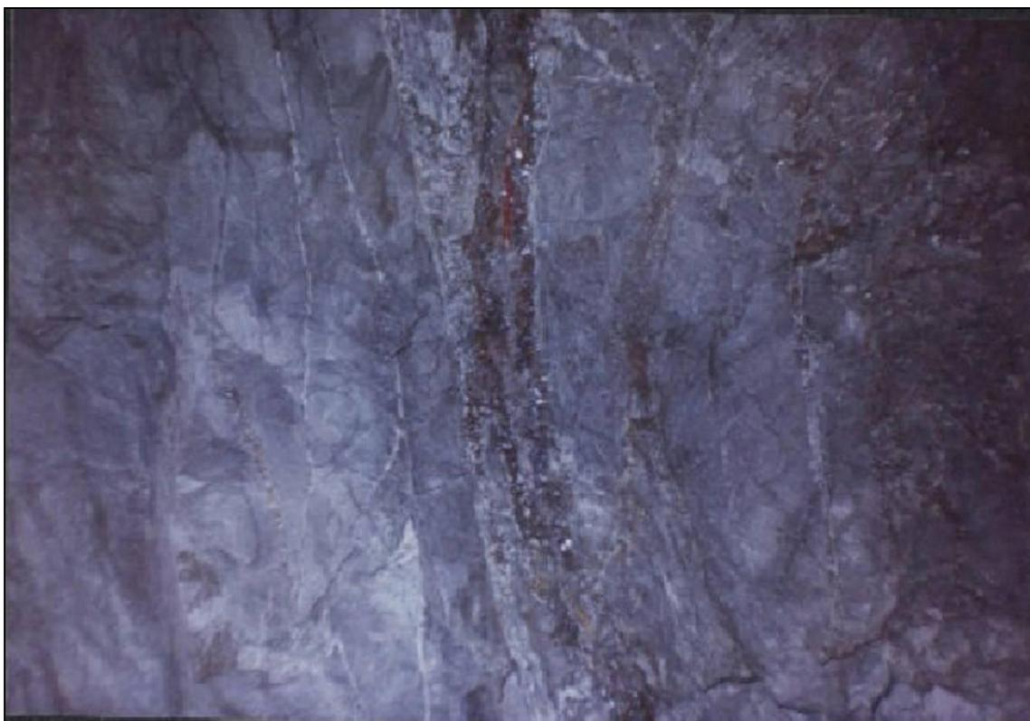
Figura 12: Bandeado y relleno de vetillas subparalelas en la veta Bienaventurada. Ancho de la zona mineralizada: 0,75 m.
