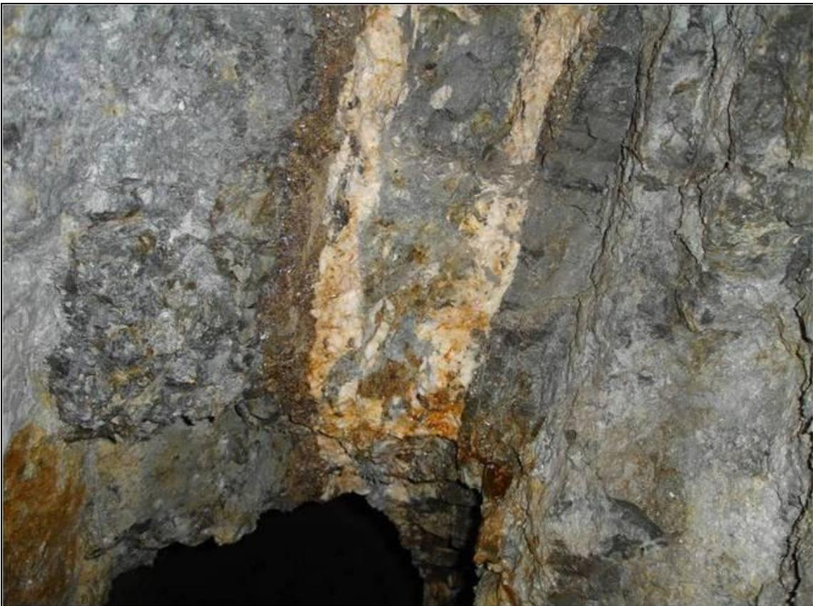
Figura 9: Vista de la veta Esperanza en el interior de la mina (nivel 630), englobando un gran fragmento de roca. Ancho de la zona mineralizada: 1,20 m.
