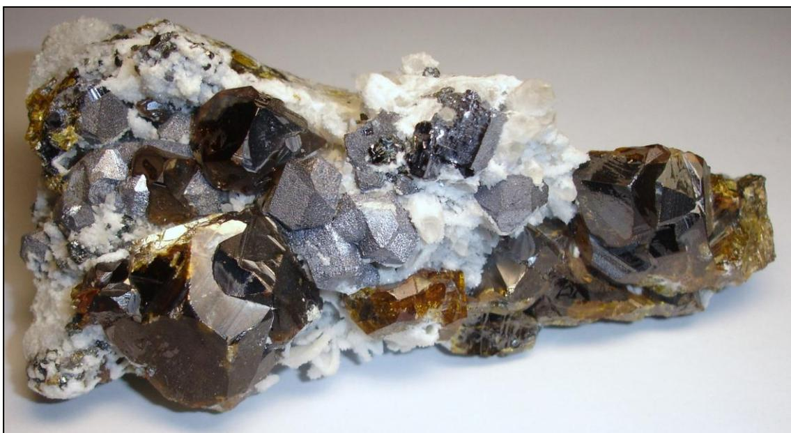
Figura 15: Cristales de esfalerita y galena, en ganga de cuarzo y barita (reemplazada parcialmente por cuarzo). Mina Esperanza. Longitud del ejemplar: 9,5 cm.
