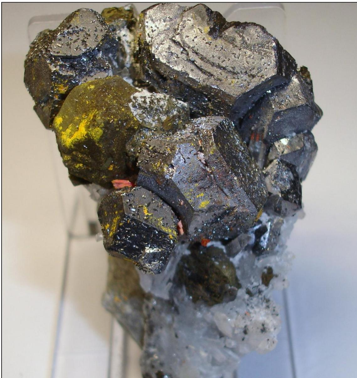
Figura 20: Cristales de galena y esfalerita, recubiertos por seligmannita; además la esfalerita está recubierta parcialmente por una pátina de oropimente, en matriz de cuarzo y barita. Mina Palomo. Tamaño del ejemplar: 8 cm x 6 cm.
