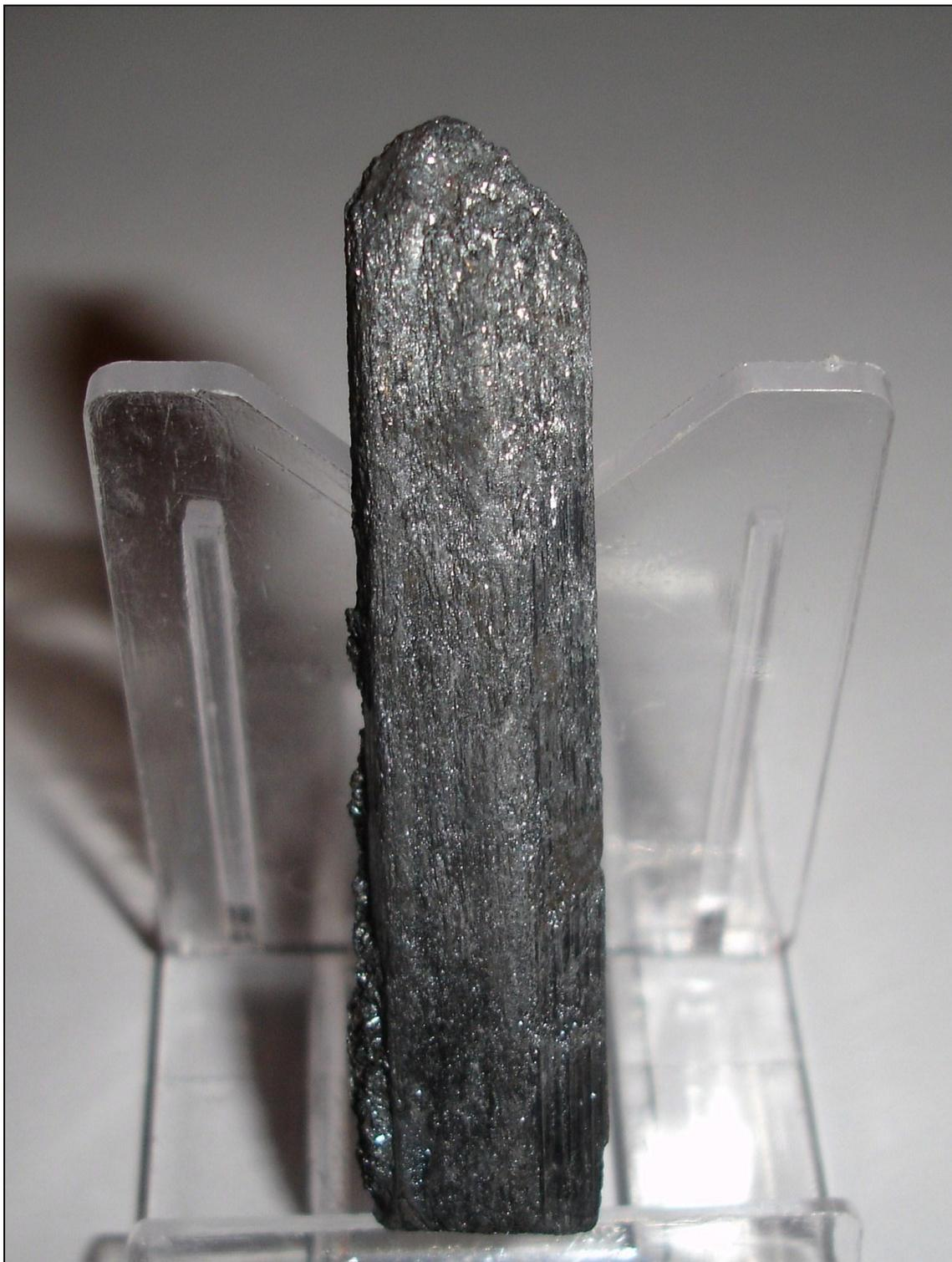
Figura 43: *Cristal aislado de estibnita. Mina Esperanza. Longitud del cristal: 6 cm.*
