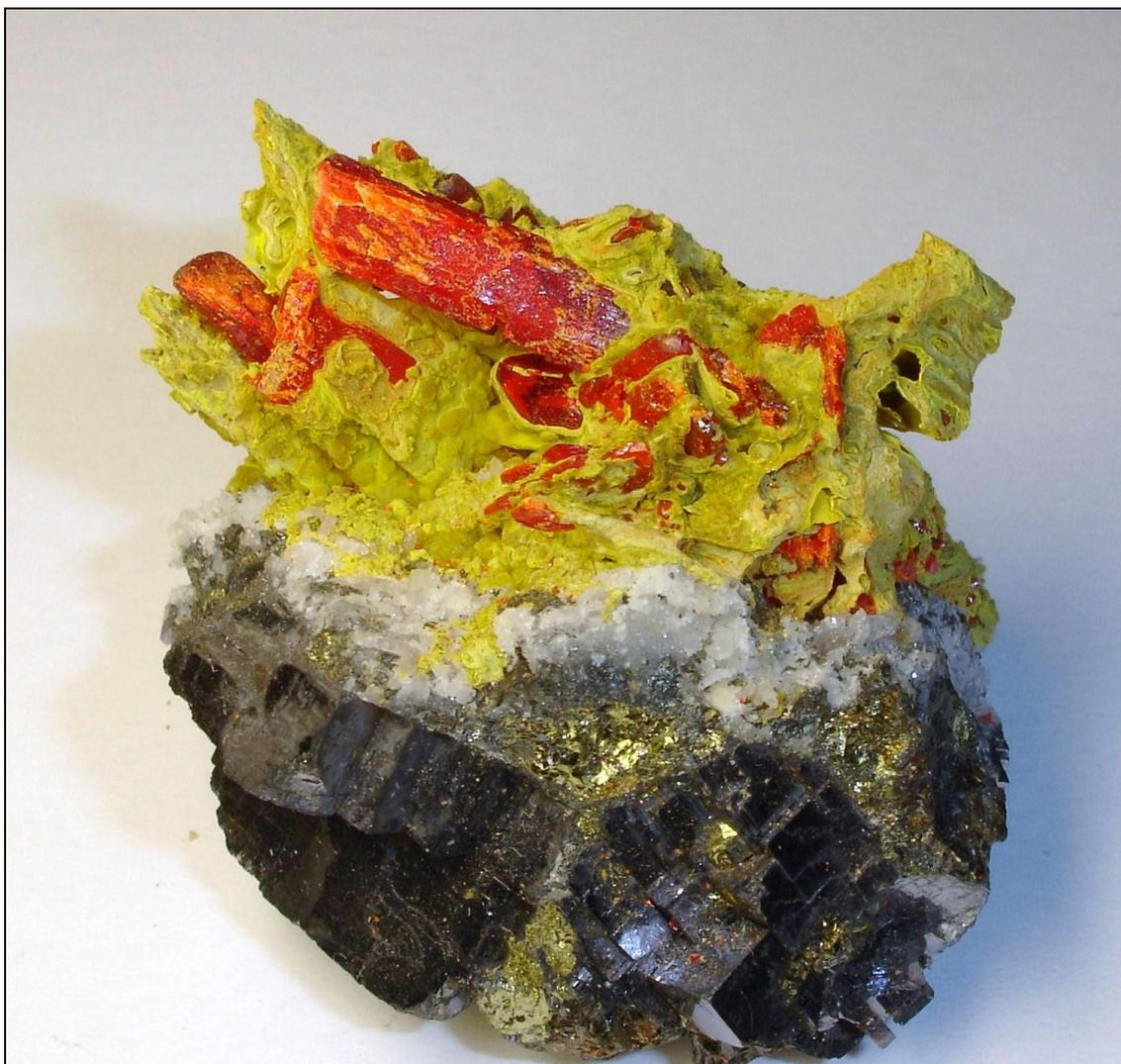
Figura 37: Cristales de rejalgar recubiertos por una pátina de oropimente en una matriz de galena, pirita, cuarzo y barita. Mina Palomo. Longitud del cristal principal de rejalgar: 2,8 cm.
