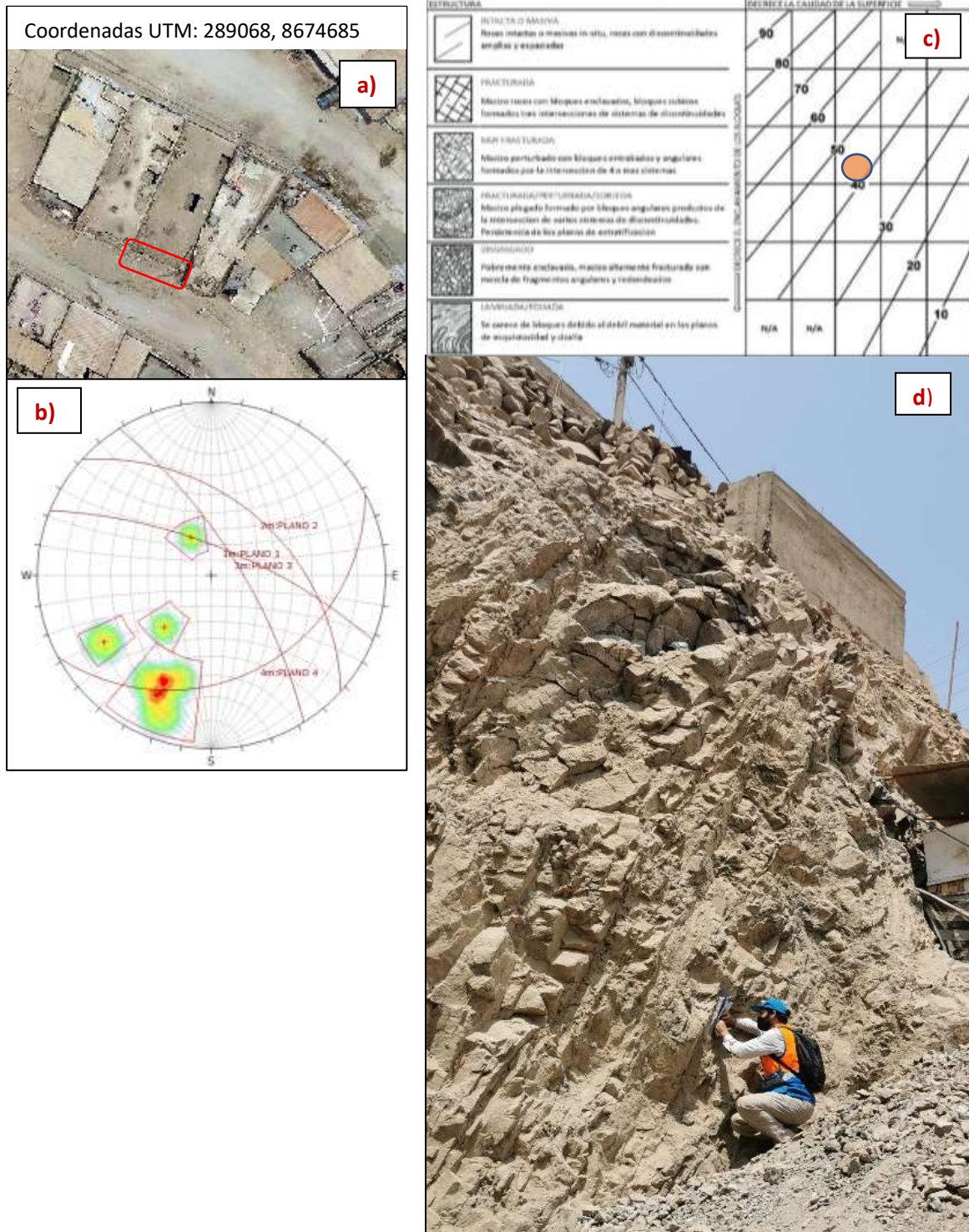
Cuadro N° 4 -Afloramiento C: a) Ubicación del afloramiento, b) Proyección estereográfica de los planos de fractura representativos mediante DIPS, c) GSI, d) Fotografía del afloramiento.
