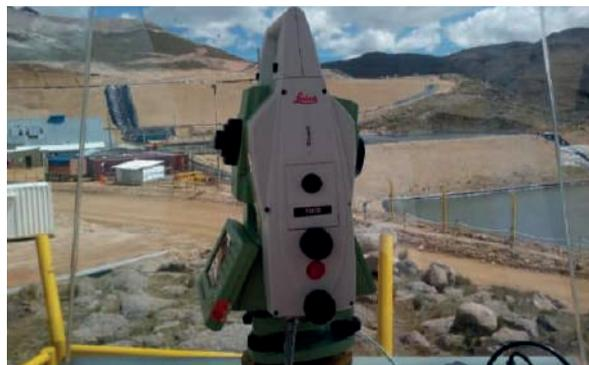
Foto 1: Estación total de monitoreo automatizado Leica TM30 sistema GEOMOS.
