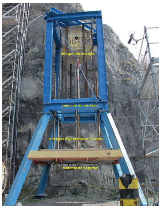
Fig. 2 Estructura del ensayo
