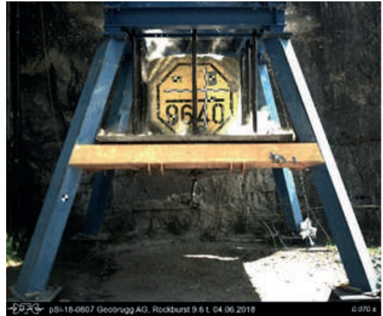
Fig. 6. Impacto del bloque de hormigón sobre el macizo rocoso simulado
