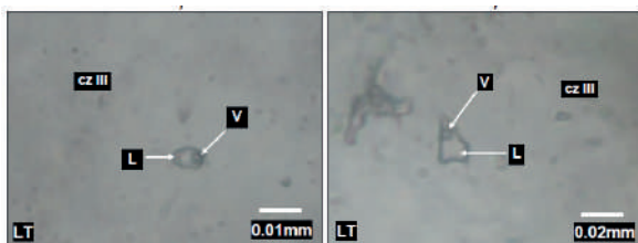
Figura N°7: Inclusiones fluidas primarias bifásicas ricas en líquido con formas ovaladas e irregulares con tamaños inferiores a 8µm capturas en cuarzo de relleno
