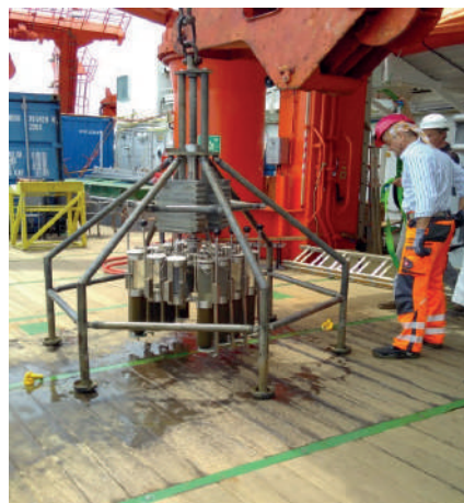
Figura 1 Batimetría de la zona de estudio (Velazco et al, 2018) y estaciones de muestreo (izquierda) y equipo de muestreo Multisacatestigos empleado en el crucero M135 (izquierda).
