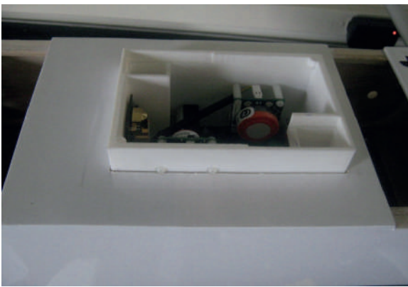
Figura 4. Caja de sensores, vista sin tapa en el chasis del avión.
