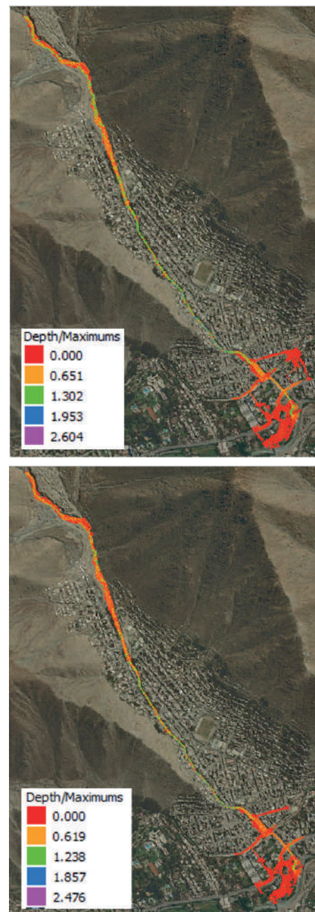
Figura 3: Alturas máximas del flujo aluvional empleando los datos del PX-1000 (a) y el método de tormentas del SCS (b).
