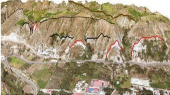
Figura 03: Deslizamientos de tipo rotacional con escarpes (líneas rojas) del orden de 84 (a), 109 (b) y 176 m (c) de longitud y saltos con desnivel de 11 (a), 12 (b) y 4.1 (c) m.
