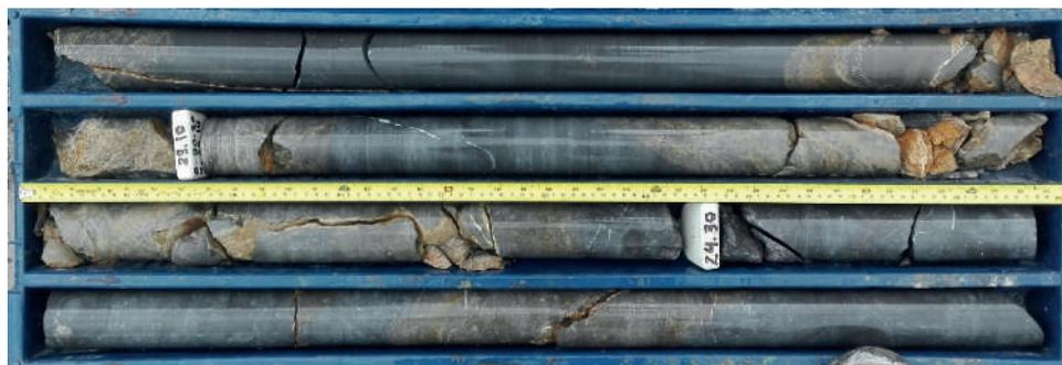
**Figura 1.** Caja de testigos de perforación que muestra el fracturamiento presente en el macizo rocoso (Caliza micrítica, Formación Jumasha), se diferencian fracturas rellenas y fracturas cerradas.
