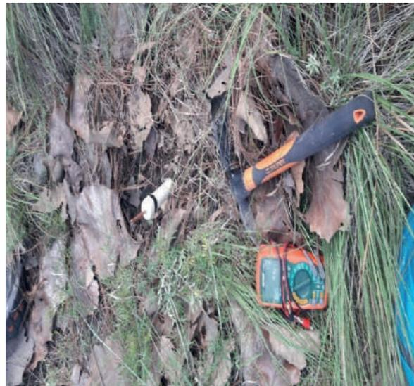
Figura 2. Equipo utilizado. En la parte superior se encuentra un electrodo, en la parte inferior izquierda se encuentra el multímetro de alta impedancia y en la parte inferior derecha la picoleta.
