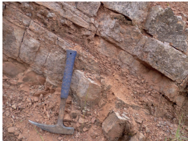
Figura 3. Fallas normales sinsedimentarias en las facies coluviales (izquierda) y fluviales (derecha) del Grupo Mitu con dirección de extensión NW-SE.
