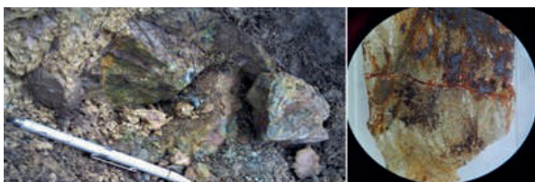
Figura 10: Anfíbol (minerales de tremolita-actinolita) en contacto entre el intrusivo y la roca caja. A la derecha: microfotografía en Microscopía óptica de Anfíbol.
