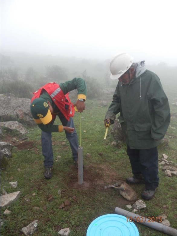
Fotografía 2. Ensayo de infiltración en el sector Callahuanca-Chauca.
