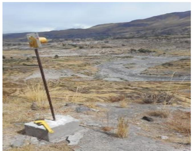
Foto 01: Punto de control instalado en zonas potencialmente inestables en Lari.
