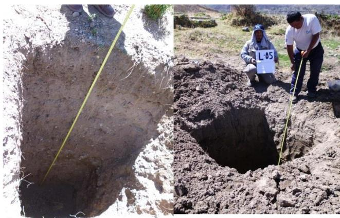
Foto 03: Calicata realizada en el distrito de Lari, con 2.80 m de profundidad, el perfil detalla que está conformado por suelos finos tipo limos, arcillas y arenas con presencia de clastos sub redondeados de pequeño diámetro aproximadamente de 0.3 '' y no se observó presencia de nivel freático.
