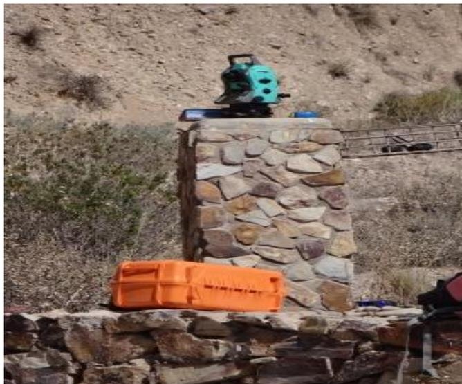
Foto 02: Base de medición y estación total con que se realizaron las mediciones EDM
