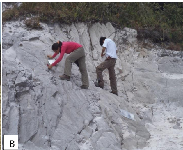
Fotografía 1. A) Cantera Peña Blanca: Secuencia de arenitas cuarzosas levemente compactadas de grano fino a medio, color blanco cremoso; en estratos de 10 a 30 cm de espesor. B) Ocurrencia Huilcabamba. Arenitas cuarzosas algo compactadas de grano medio a fino y un menor porcentaje de granos grueso, de color gris; en estratos de 5 a 30 cm de espesor.
