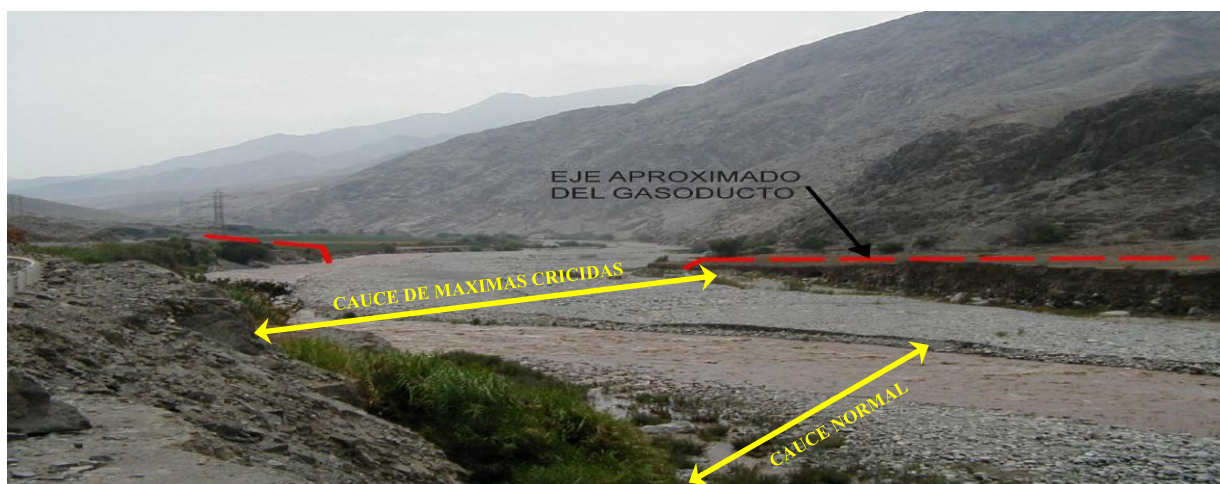
Figura 2. Cauce de avenida normal y de máximas avenidas, o también de máximas crecidas. El cauce normal es divagante en los ríos anastomosados, y la contracción del flujo puede darse en cualquier parte del cauce de máximas crecidas.
