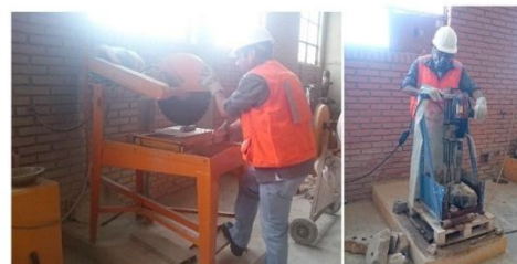
Imagen 02 preparación de los testigos para ensayos de corte directo y compresión triaxial.
