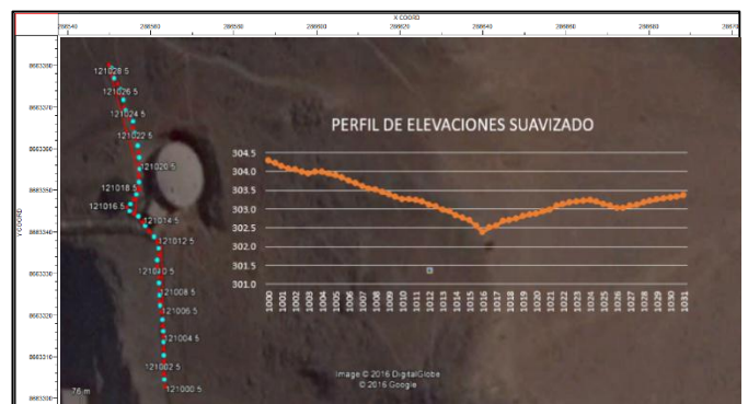
Figura1. Distribución de la línea sísmica y la línea de tomografía
