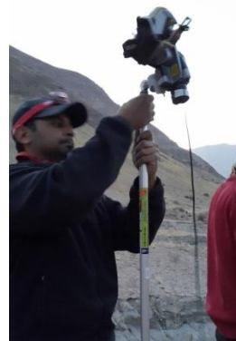
Figura 2. Cámara infrarroja empleada en las mediciones IR en el proyecto Huayruro.
