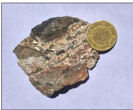
**Fig.5** – Muestra extraída de la veta, parte cercana a las cajas. Se observa la alteración generada por el emplazamiento de fluidos, además de la presencia de óxidos como parte de la composición, los fluidos en su emplazamiento destruyen parte de la mineralogía preexistente.
