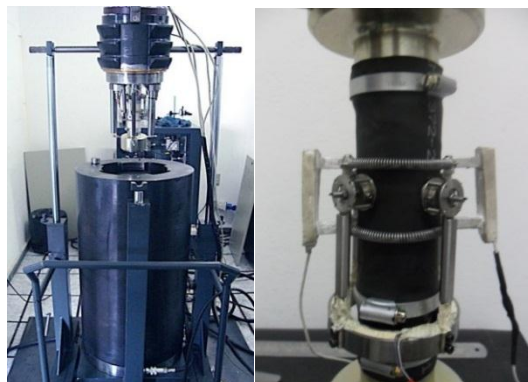
Figura 3. Célula triaxial de alta rigidez y cuerpo de prueba instrumentado con clips gages.
