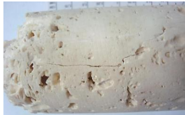
Figura 12. Propagación de la fractura a través de las puntas de los poros como es descrito en la teoría de Griffith
