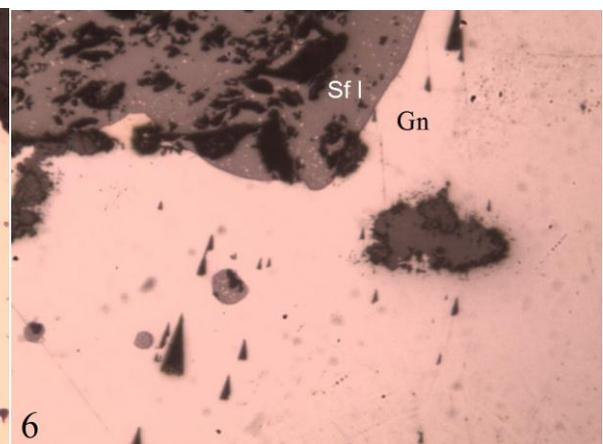
**Fig.-6.** Esfalerita con "chalcopirite disease" en galena masiva relleno de vetilla.
