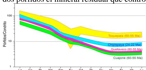
Fig. 6. Diagrama del perfil de concentraciones de REE para los intrusivos del pórfido Cu-Au Chipispaya, también se muestra los perfiles de concentración de los pórfidos de Cu-Mo más importantes del Sur de Perú. Claramente resalta que el perfil de Chipispaya es diferente al de Cuajone, Quellaveco y Toquepala.
