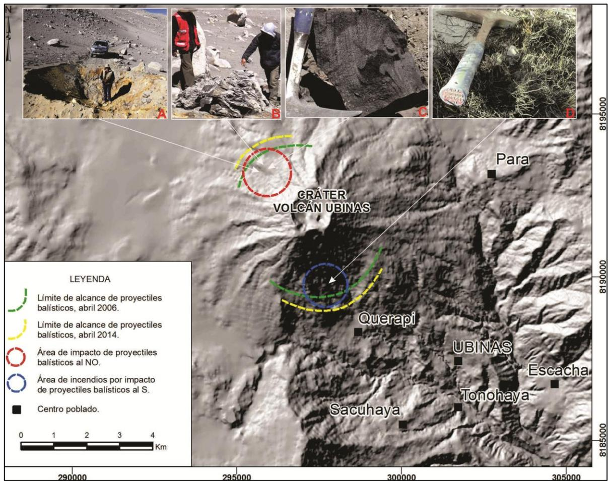
**Figura 3.** Alcance de proyectiles balísticos durante el 2006 y abril 2014. En recuadro: a) cráter de impacto de 4.5 m de diámetro y 1.6 m de profundidad, a 1.9 km de distancia del cráter; b) balístico de 1 m de largo y 0.4 m de ancho, eyectado a 1.8 km del cráter; c) detalle de balístico, se aprecian estructuras de flujo, así como textura vesicular; d) ichu calcinado durante el impacto de proyectiles balísticos.
