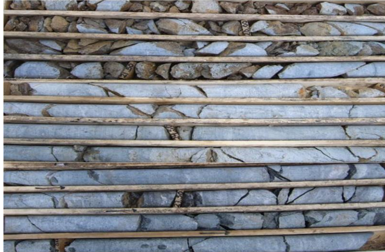
Fotografía 4. Núcleos de perforación en rocas donde se evidencia la disminución del fracturamiento con la profundidad.
