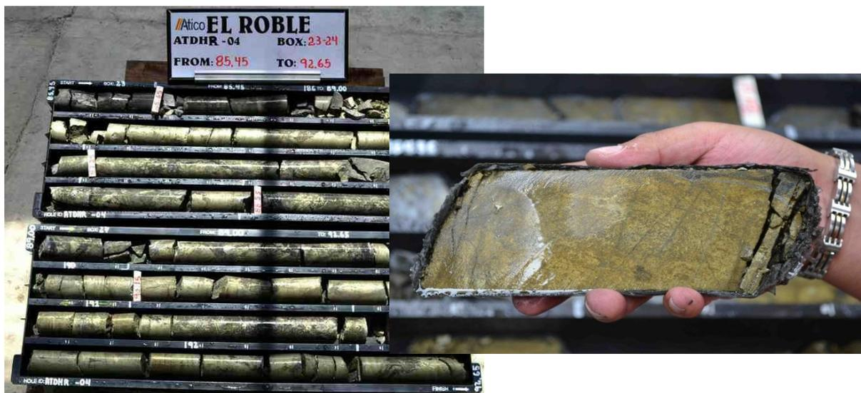
*Figura 2. Testigos de perforación del pozo ATDHR-04 que intercepto de 41 m. a 6.5% Cu y 17.6 g/t Au en el cuerpo de sulfuros masivos “Maximus”.*
