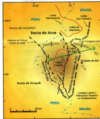
Figura 3. Mapa de localização e de arcabouço estrutural da Bacia do Acre, delimitando a seção geológica sintética a ser modelada. A linha sísmica intersecta de forma transversal a bacia, praticamente W-E e é delimitada pelo intervalo A-B (modificado de Cunha, 2006).
