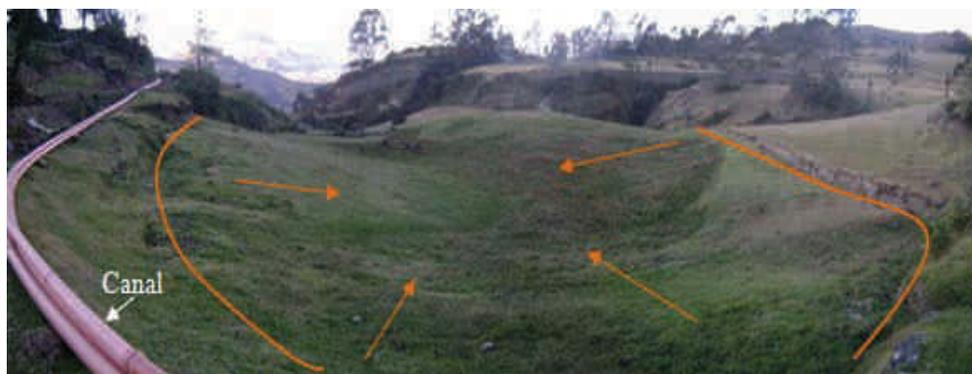
Foto 3. Ahondamiento en la parte central del cuerpo del deslizamiento
