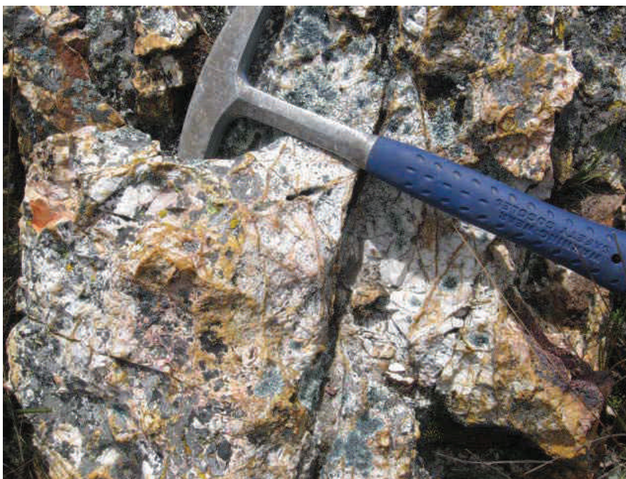
Foto 1. Prospecto Pallcamachay. Zonas de Stockwork de venillas del tipo B y D. Predominante alteración Filica (Intensa). Roca Caja: Volcánicos Calipuy.
