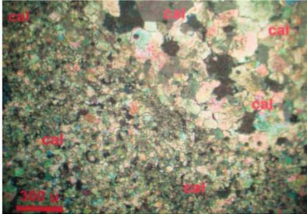
Foto 2.- Agregados microcristalinos de calcita (cal) algo dolomitizados, hacia la derecha se observan a las calcitas (cal) recristalizadas. 40X.
