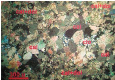
Foto 3.- Agregados microcristalinos de calcita dolomitizada (cal + dol) y escasos cristales de clorita (clo), en este sector se pueden observar a las calcitas (cal) algo recristalizadas. 40X.
