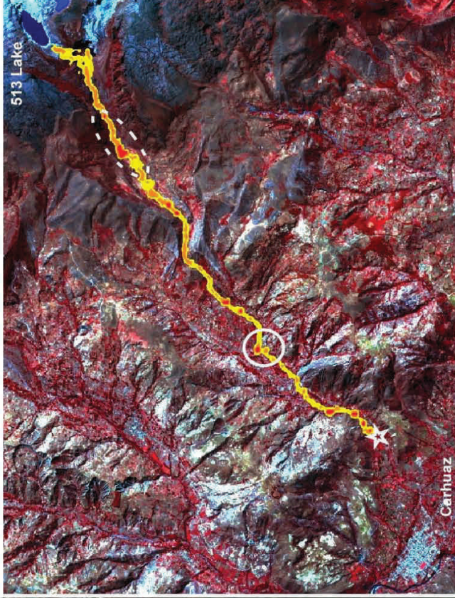
Figura 06: Der. Imagen de Jaxa posterior al evento. Izq. Simulación FLO 2D antes del evento. Con líneas entrecortadas se aprecia las grandes zonas de disipación de energía producto de los cambios de pendiente. En línea continua se aprecia las áreas más susceptibles a run ups, en esta zona hubo varias viviendas afectadas. La estrella marca el límite de la turbulencia, desde ahí el flujo de derritos se convierte en una inundación, que sigue el cauce del río pre establecido naturalmente.
