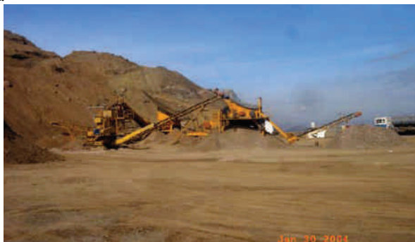
Figura 1. En la imagen de la izquierda se puede observar la extracción de los estériles generados durante la apertura de la corta Los Blancos en La Sierra Minera de Cartagena-La Unión como áridos para la construcción.
