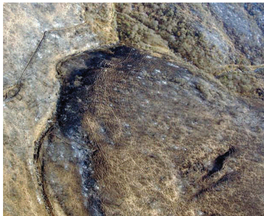
Figura 3. Se observan las terracillas que evidencian la inestabilidad de la ladera, adicionalmente, en A, el carcavamiento.
