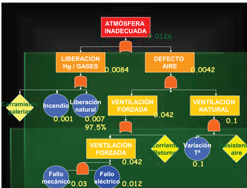
Fig 4. Esquema simplificado de las etapas que acaecen en el fallo que conducen a una atmósfera con peligro
