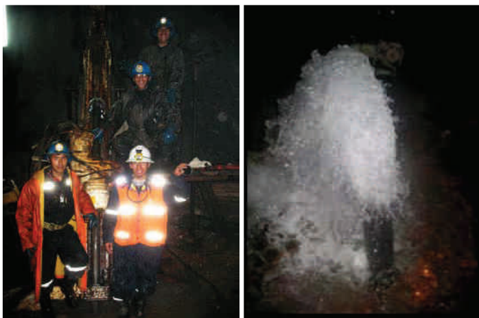
Figura 3. Perforación de sondeos de investigación hidrogeológica, descarga y medida de presiones de las aguas subterráneas confinadas
