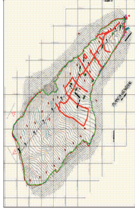
Gráfico 1: Perfiles de levantamientos con Georadar (RAMAC), para determinar los espesores de la lengua glaciar de Chaupijanca.
