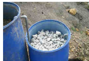
Fig. 3: Piloto, neutralización con caliza Minera Colquirumi Cajamarca
